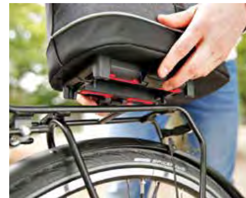
Schnellbefestigungs-Clip passen auf fast jeden Gepäckträger.
